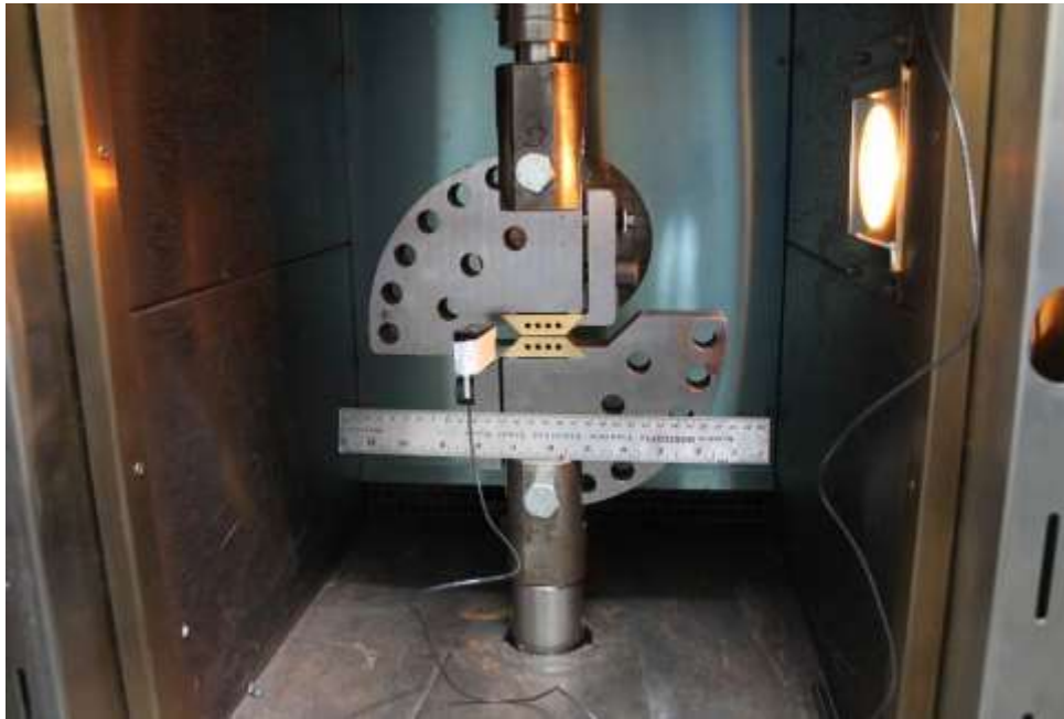
Machine de traction permettant de caractériser les éprouvettes Arcan
